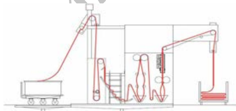
شکل ۱: شماتیک کلی از اصول کار دستگاه استرچ [۷]
