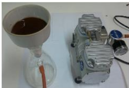
شکل (۱): دستگاه و کیوم همراه با مجموعه صافی
