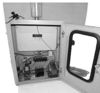
شکل 1 دستگاه MQL استفاده شده جهت انجام آزمایش
