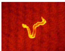
شکل ۵: لیف اکریلیک و پارچه آن (کلاه اسکی سیاه رنگ) زیر میکروسکوپ فلورسانس
