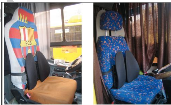
شکل ۵- تطابق ضعیف و متوسط پشتی اسپاین فیت با صندلی راننده در اتوبوس های واحد مدل "آکیا" و "بنز"
