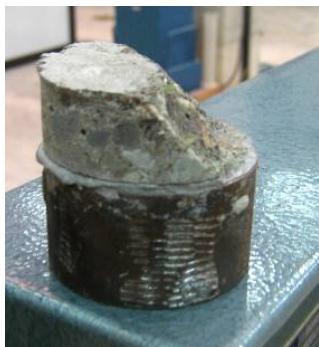
ب) لایه تعمیر پس از انجام آزمون شکل ۳ نحوه انجام آزمون پیچش
